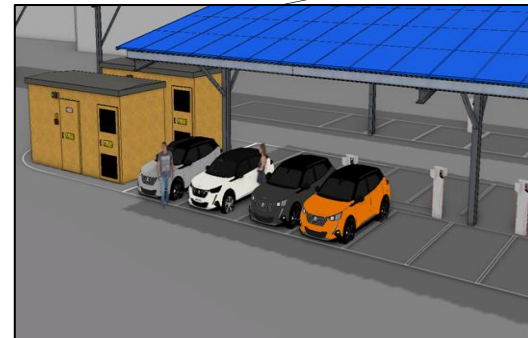
Installation de 2 postes électriques de transformation HTA pour production photovoltaïque et alimentation des bornes de recharge.
