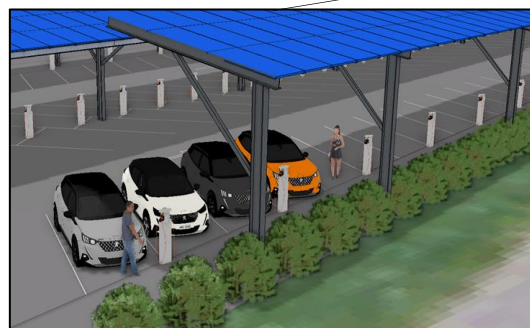
Installation de bornes de recharge pour véhicules électrique sous les ombrières
